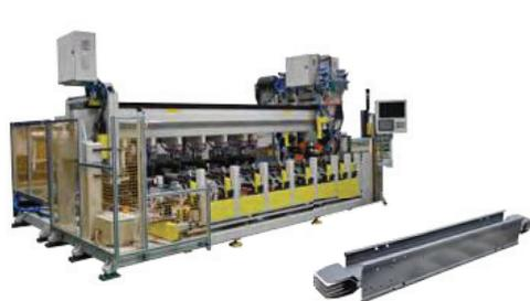
■ Сварочное оборудование для автоматических выключателей в литом корпусе
