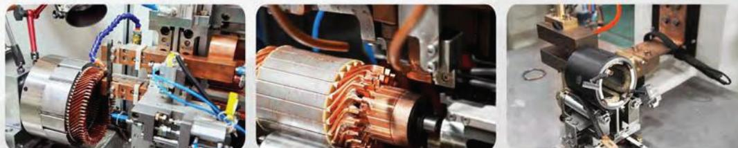
■ Сварочное оборудование для статоров двигателей
