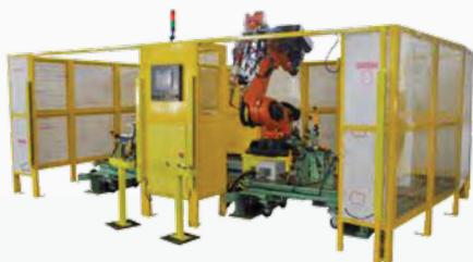
■ Сварочное оборудование для гаек крепления колес и колпачков автомобильных шин
