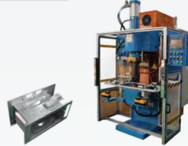
20000 Дж Сварочный аппарат постоянного тока для микроволновых печей
