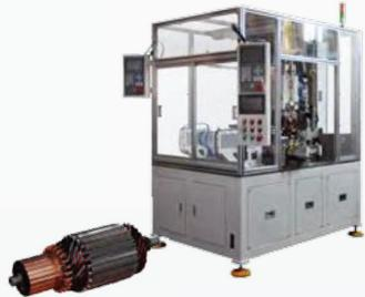
55 кВа Сварочный аппарат постоянного тока средней частоты для каркасов
