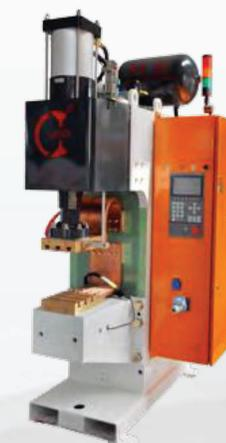
250/440 кВА MFDC аппарат для пневматической точечной сварки / сварочный пресс DB - 250/440 - T1L00
