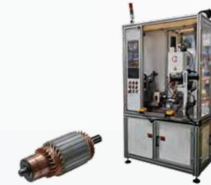
■ Сварочное оборудование для статоров двигателей
