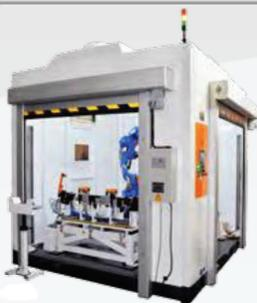
Роботизированная рабочая станция сварочного пресса
