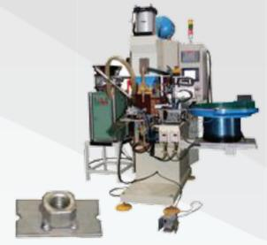
330 кВа Аппарат для точечной сварки постоянного тока средней частоты/сварочный пресс
