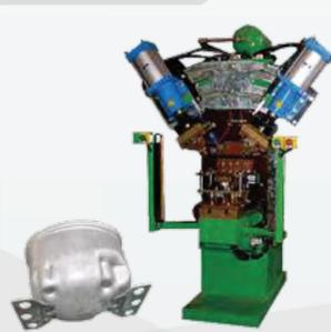
■ Оборудование для автоматической сварки для кронштейнов и всасывающих труб
