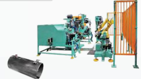
■ Оборудование для автоматической сварки для вентиляционной трубы и болтов крышек
