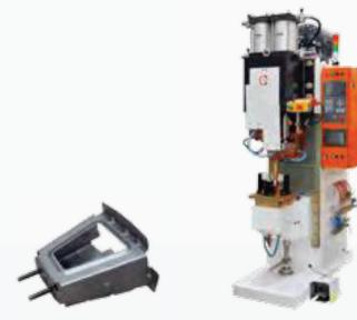
250 кВа Аппарат для точечной сварки постоянного тока средней частоты/сварочный пресс
