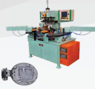
100 кВа Сварочный аппарат переменного тока для крышек топливных баков
