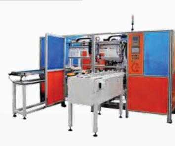
Автоматический сварочный аппарата для крышек топливных баков
