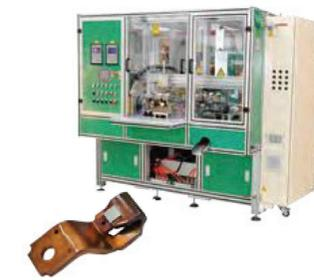
4440 кВа аппарат для контактной сварки постоянного тока средней частоты Статический контакт с 6 станциями
