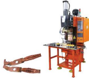
880 кВа Сварочный аппарат постоянного тока среднего напряжения для подвижных контактов
