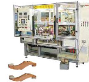
Статический контакт с 6 станциями 55 кВа аппарат для контактной сварки постоянного тока средней частоты
