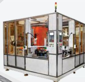
■ Сварочное оборудование для автомобильных стоек А\В\С
