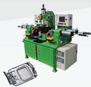
330 кВа Сварочный аппарат постоянного тока средней частоты для корпусов крышек топливных баков
