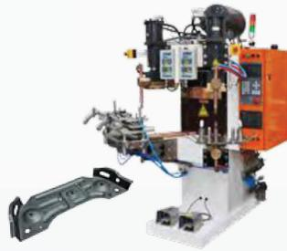
■ Сварочное оборудование для систем переключения автомобильных коробок передач
