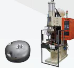
220 кВа Автоматический сварочный аппарат постоянного тока средней частоты для релейных коробок
