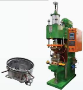
660 кВа Сварочный аппарат постоянного тока средней частоты для фузита
