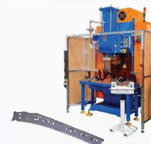
■ Станок для расплющивания выводов для автомобильных люков
