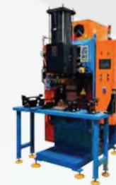
20000 Дж Аппарат для точечной сварки постоянного тока/сварочный пресс
