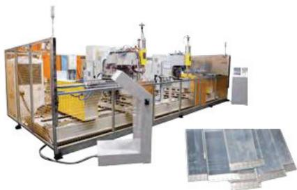
Станок для расплющивания для автоматической сборки люминиевых электрических шин
