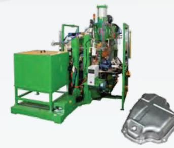
15000 Дж Сварочный пресс постоянного тока средней частоты для крышек топливных баков
