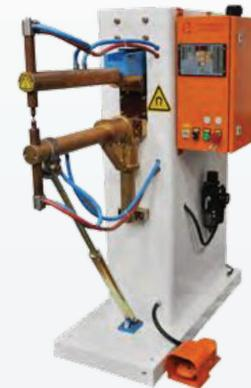
25/50 кВА Пневматический аппарат для сварки с радиальным ходом хобота переменного тока DN - 25/50 - 14001
