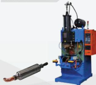
■ Автоматический сварочный аппарат для компрессоров холодильных установок.
