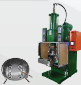
220 кВа Сварочный аппарат постоянного тока средней частоты для опорных кронштейнов
