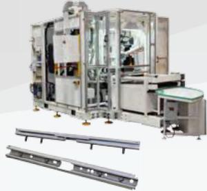
130 кВа Аппарат для точечной сварки постоянного тока средней частоты для рельсов автомобильных сидений
