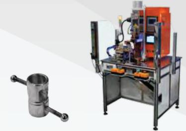
■ Сварочное оборудование для компрессора системы кондиционирования воздуха
