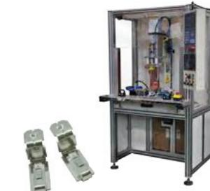
110 кВа Полностью автоматический сварочный аппарат для серебряных контактов
