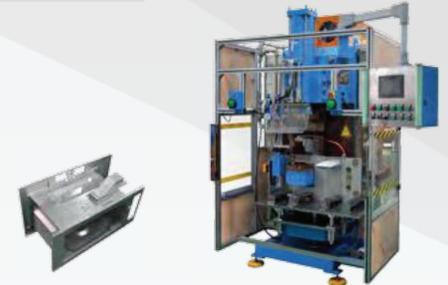
50Т Станок для расплющивания выводов для микроволновой печи
