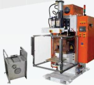
10000 Дж сварочный аппарат для задних длинных кромок
