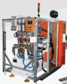
110 кВа аппарат для точечной сварки постоянного тока средней частоты/сварочный пресс
