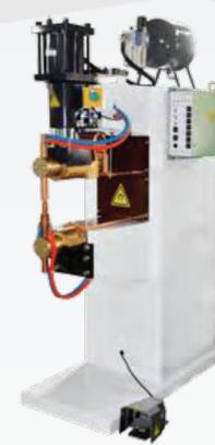
25/35/50 кВА Пневматический аппарат для точечной сварки переменного тока/сварочный пресс DN - 25/35/50 - AA0\*\*
