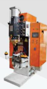
220 кВа Сварочный пресс постоянного тока средней частоты для крышек топливных баков
