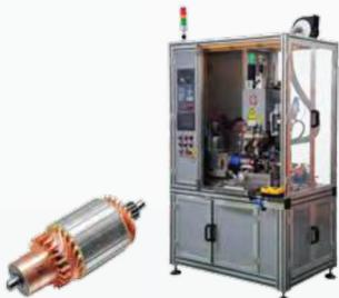
55 кВа Сварочный аппарат постоянного тока средней частоты с сервоприводом для каркасов
