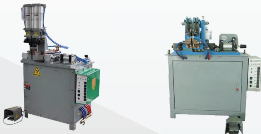
50/63 кВа Машина для стыковой сварки с вертикальным сварочным прессом
