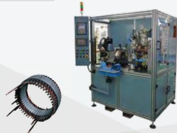
■ Сварочное оборудование для вентиляторов роторов
