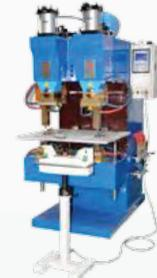
■ Сварочное оборудование для водяных насосов
