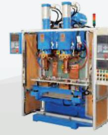
440 кВа Сварочный аппарат постоянного тока средней частоты для корпусов микроволновых печей и отсеком для двигателя
