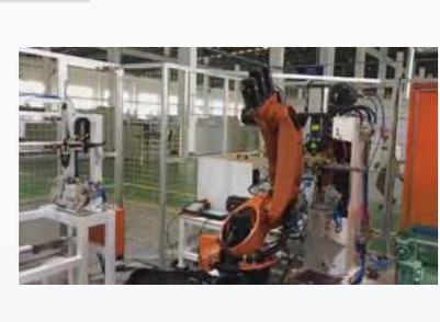
■ Сварочное оборудование для амортизаторов
