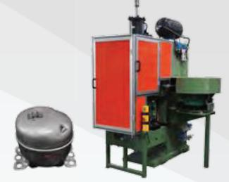
■ Сварочное оборудование для компрессоров холодильных установок
