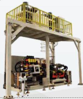
■ Сварочное оборудование и станки для расплющивания для посудомоечных машин
