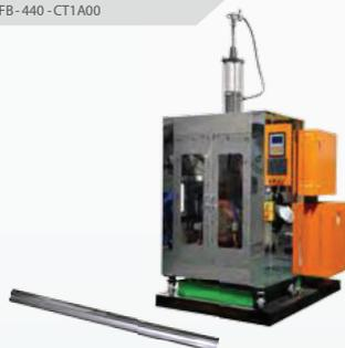
12000 Дж Сварочный пресс постоянного тока с тремя головками для автомобильных стеклоподъемников
