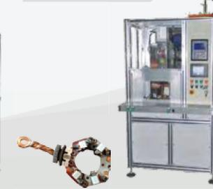
330 кВа Сварочный аппарат постоянного тока средней частоты для стартеров автомобилей
