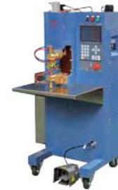
55 кВа Настольная машина для точечной сварки постоянного тока средней частоты со столиком
