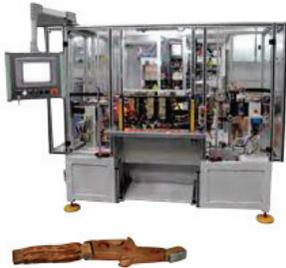
440 кВа Аппарат для точечной сварки постоянного тока средней частоты/сварочный пресс
