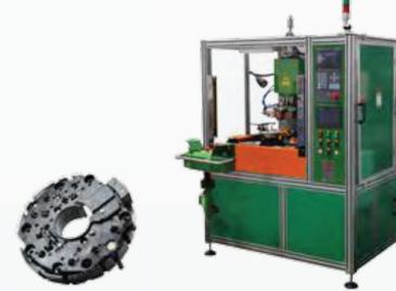
55 кВа Сварочный аппарат постоянного тока средней частоты для мостовых выпрямителей
