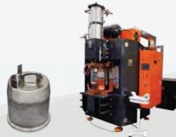
60000 Дж Конденсаторный аппарат для точечной сварки/сварочный пресс с 8 станциями
