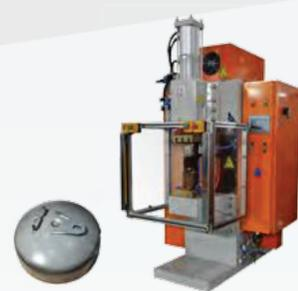
15000 Дж Сварочный аппарат постоянного тока для подвесок
