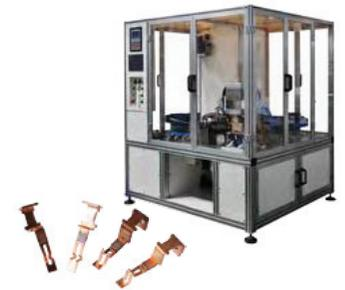
110 кВа Полностью автоматический сварочный аппарат для серебряных контактов
