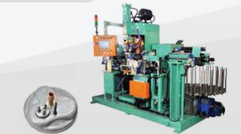
■ Сварочное оборудование для всасывающих труб и фюзитов
