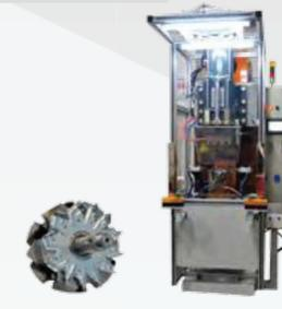
110 кВа Аппарат для сварки вентиляторов двигателей постоянного тока средней частоты к ротору
