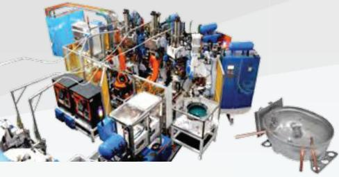
165 кВа Автоматический сварочный аппарат постоянного тока средней частоты для релейных коробок
