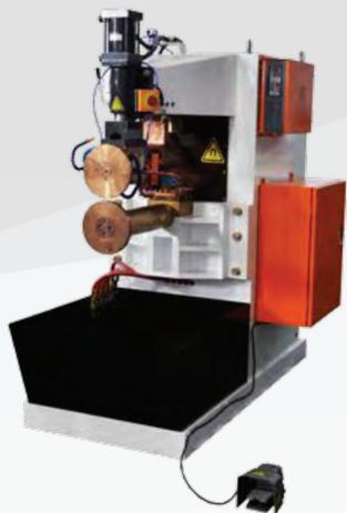
50/80/100/150/200 кВа пневматический аппарат для шовной сварки переменного тока
