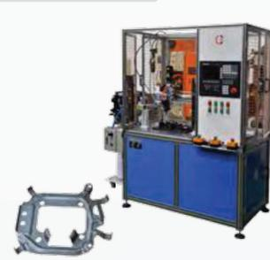
100 кВа Склепывающий аппарат переменного тока для крышек топливных баков
