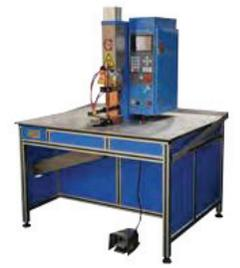
Статический контакт с 6 станциями 4440 кВа аппарат для контактной сварки постоянного тока средней частоты
