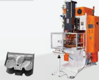
200 кВа Аппарат для шовной сварки для амортизаторов
