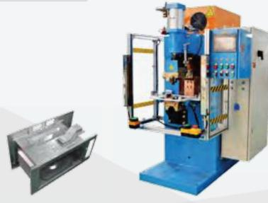
■ Сварочное оборудование и станки для расплющивания для микроволновых печей
