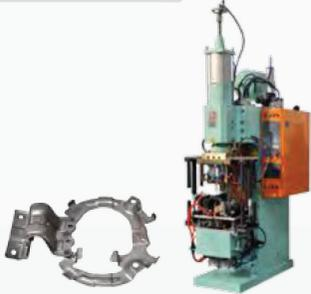
Машина для нанесения клея на внутреннюю пластину топливного бака
