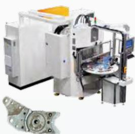
250 кВа Аппарат для точечной сварки постоянного тока средней частоты/сварочный пресс
