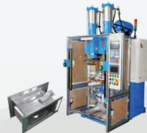
440+165 кВа сварочный аппарат постоянного тока средней частоты для корпусов и отсеком для двигателя с двумя головками микроволновых печей
