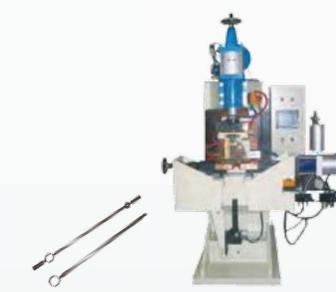
2 кДж аппарат постоянного тока для точечной сварки/сварочный пресс для систем Муфта кондиционера
