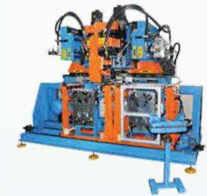
30Т Станок для расплющивания выводов для корпусов посудомоечных машин и изгибания
